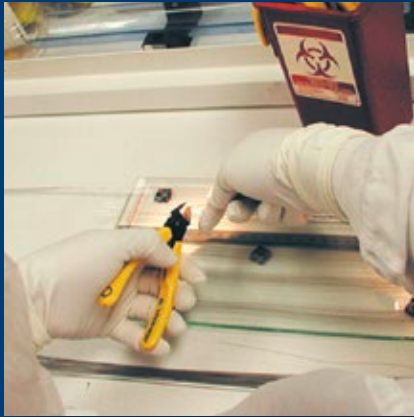
Zuschneiden eines Kathederdrahtes mit einem 8150 Seitenschneider.
