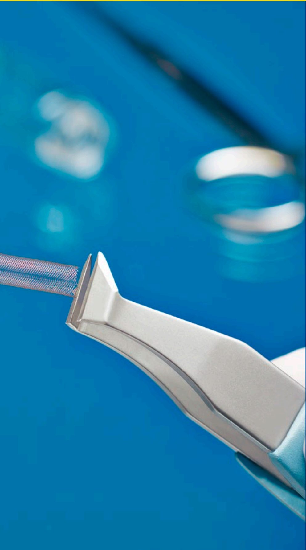
Hochqualitative Lindström Pinzette mit ESD-sicheren weichen Griffen.
