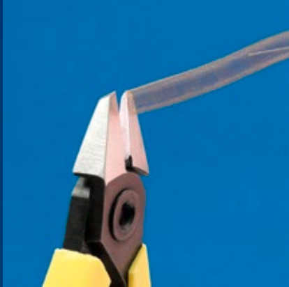
Seitenschneider, beim Zuschneiden eines Stent.
